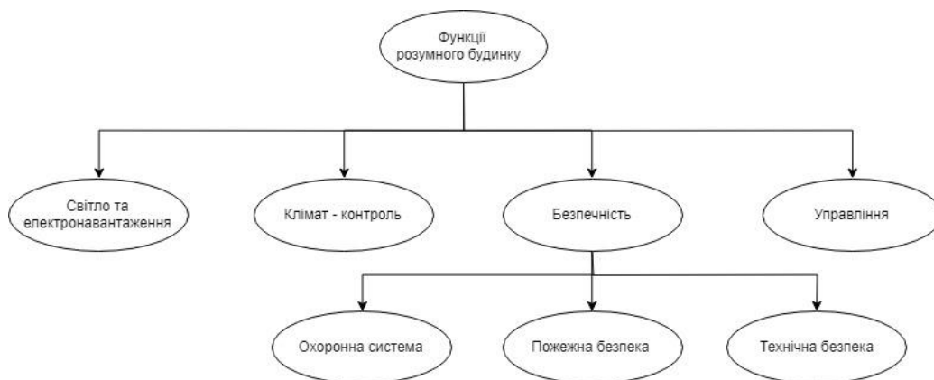
Рисунок 2 - Функціональна структура «розумного будинку»
