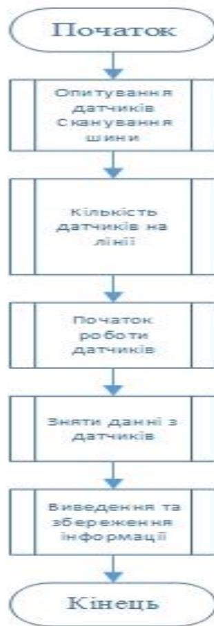
Рисунок 2 – Блок-схема макросу роботи датчиків
