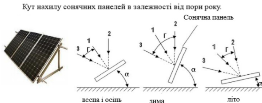
Рисунок 1 – Рекомендації щодо кута нахилу сонячних панелей, в залежності від пори року.
