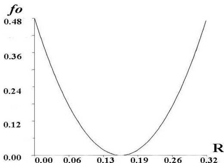
Рис. 2. График результатов расчета коэффициентной задачи при  $R = \lambda$  с параметром управления относительно коэффициента теплопроводности
