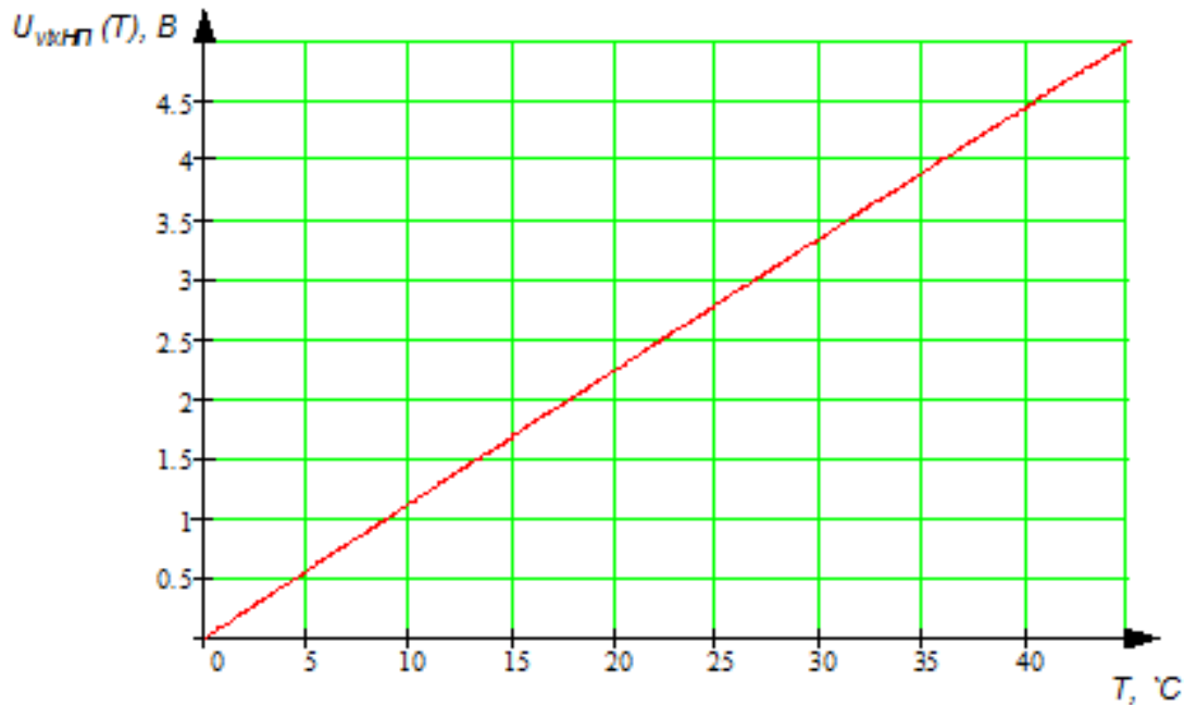
Рисунок 2.8 – Залежність напруги на виході нормуючого підсилювача від контрольованої температури
