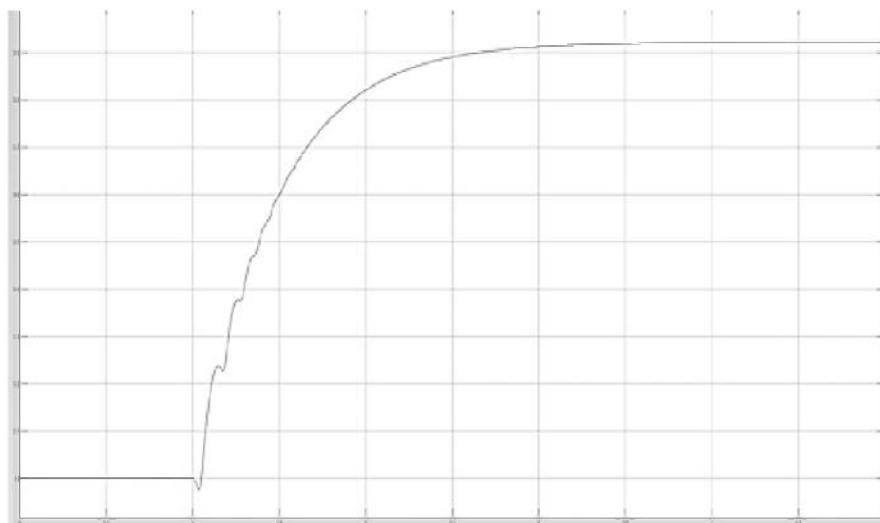
Вигляд перехідної функції системи керування положенням двомасової ЕМС за результатами моделювання
