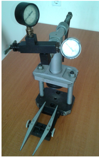
Рисунок 3.11 – Гвинтовий ручний гідролічний прес БП-29
