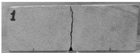
Рисунок 3.13 – Момент руйнування зразка пісковику і утворення тріщини
