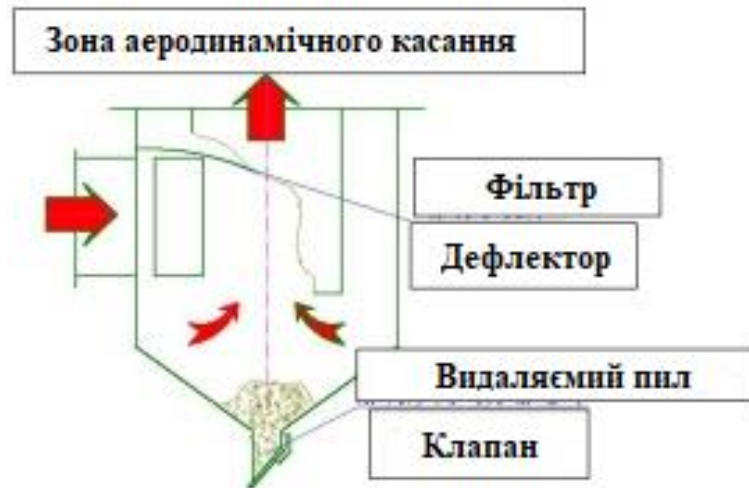
Рисунок 2.5 – Схема повітреобміну в установці
