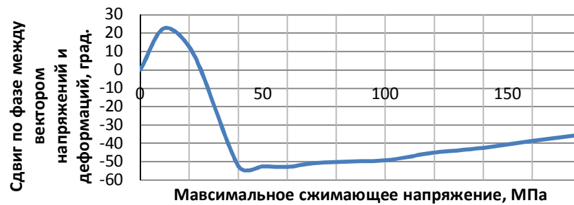
Рисунок 3 – Зсув по фазі між напруженим і деформаційним станом в зразку вугілля в процесі навантаження при узагальненому розтяжінні \sigma_1 = \sigma_2 > \sigma_3 = 22 МПа
