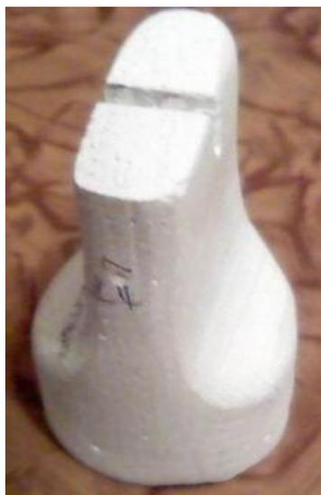
Рис. 2. Рефрактор для шпуров щелевого вруба
