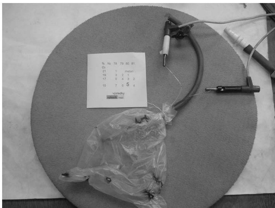
Рис.4. Иницирование воспламенения смеси размещенным в полиэтиленовом сосуде электродетонатором
