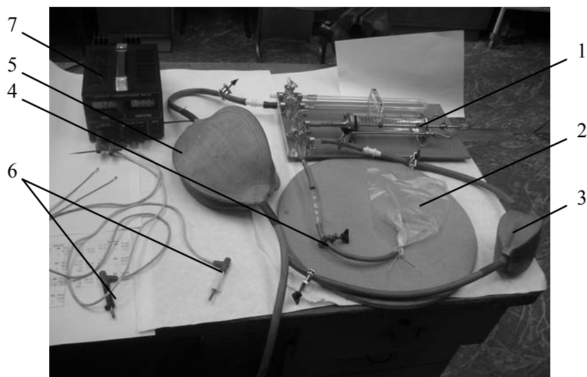
Рис.1. Общий вид лабораторной установки: 1 - дозирующее устройство; 2 - полиэтиленовая емкость для исследуемой смеси; 3 - транспортный сосуд для газового ингредиента; 4 - вентиль; 5 – промежуточная эластичная емкость; 6 – электрические контакты; 7 – источник постоянного тока 12V.
