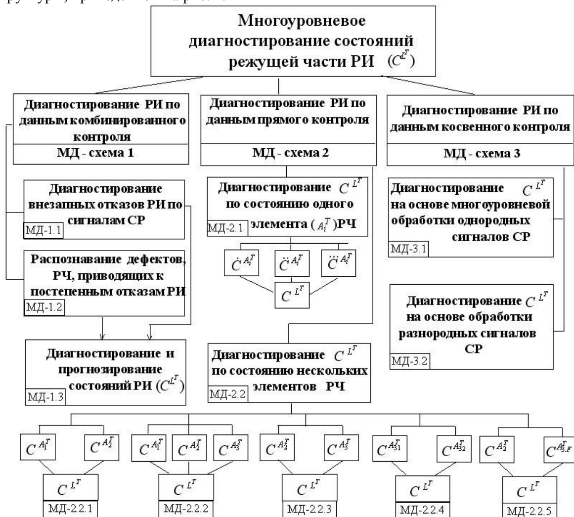
Рис. 1. Структура вариантов процессов многоуровневого диагностирования состояний режущей части инструмента
