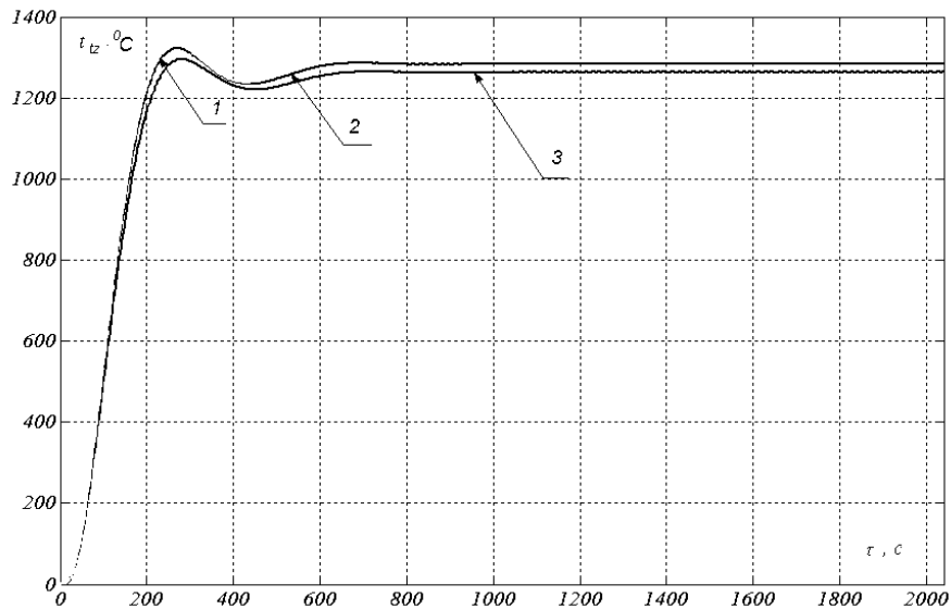
Рисунок 2– Переходный процесс по установлению температуры рабочего пространства в томильной зоне МНП ( K_p = \text{var} )
