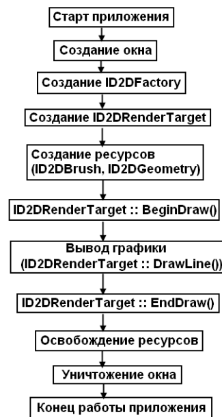
Рисунок 2 – Общая схема использования компонент Direct2D
