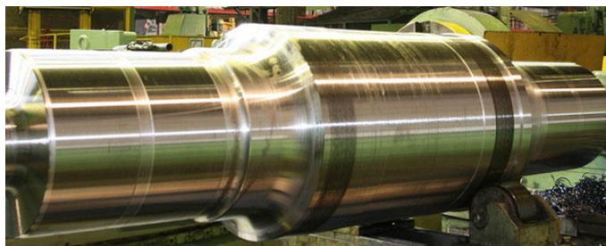
Рисунок 2 – Ексцентриковий вал, виконаний з ковкого чавуну
