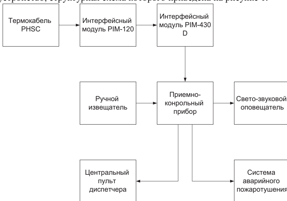
Рисунок 1 – Устройство температурного контроля линейной части магистрального ленточного конвейера
