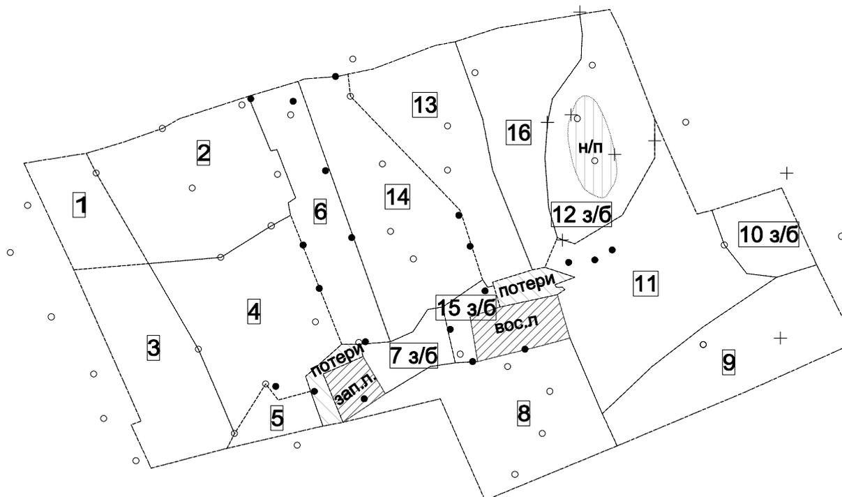
Рис. 1. Схема геологических блоков для подсчета запасов угля пласта  $k_6^g$  шахты "Никанор Новый"
