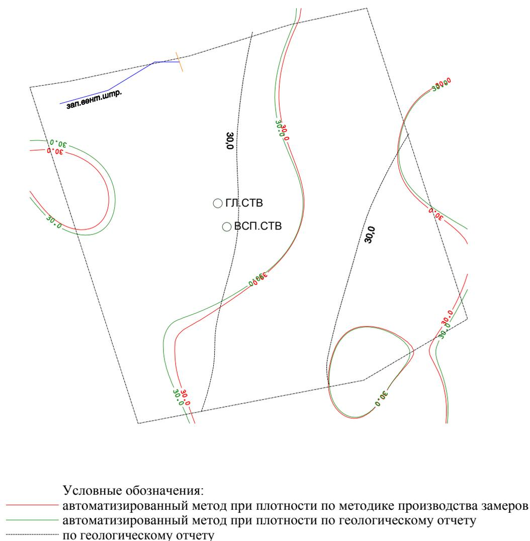
Рис. 2. Соотношение границ забалансовых запасов, построенных различными способами по пласту  $k_5$  шахты “Никанор Новый”
