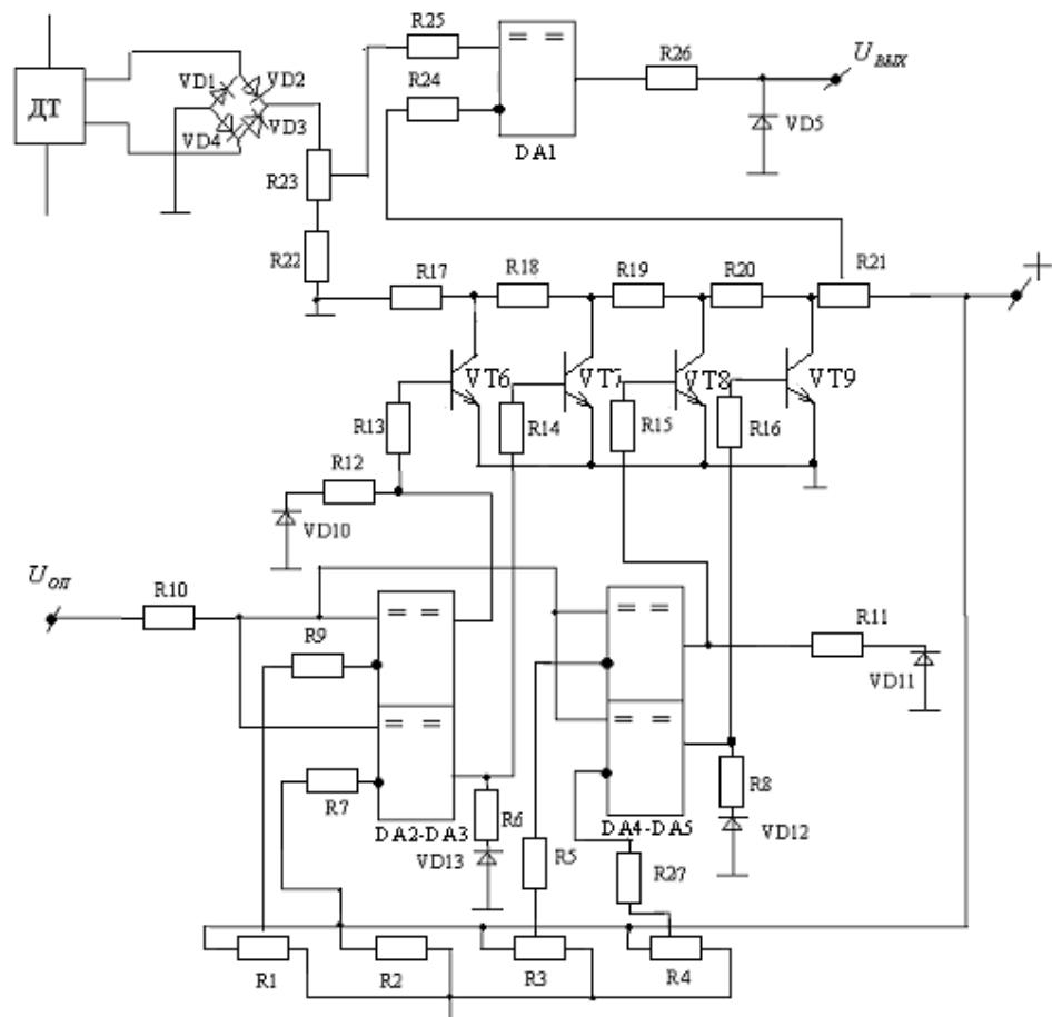
Рисунок 1 – Принципиальная схема устройства максимальной токовой защиты
